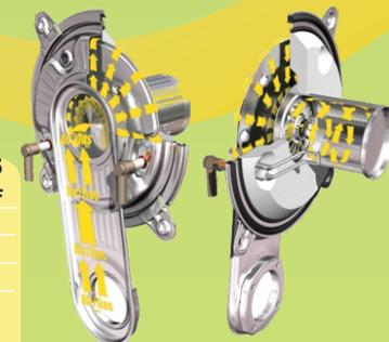
Atunci când se utilizează ARZĂTORUL CU CAPAC RECE, distribuția mixului aer/gaz pe toată suprafața capacului arzătorului, captează căldura transmisă de către combustie. Prin urmare, fluxul de intrare al mixului aer/gaz este agentul de răcire al arzătorului, și, mai mult decât atât, acest lucru permite ca amestecul aer/gaz să intre în arzător preîncălzit, optimizând astfel arderea.
